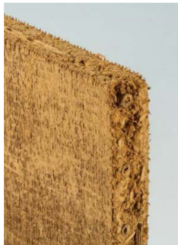
Lehmoberflächen zum Ausgleich von Luftfeuchtigkeit im Innenraum
