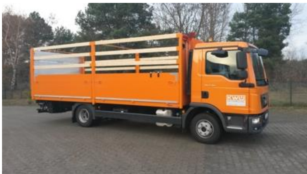
Foto 7: Pritschenwagen als „Tonnentauscher“ und Sammelfahrzeug für Elektrogroßgeräte inklusive Kühlschränke
