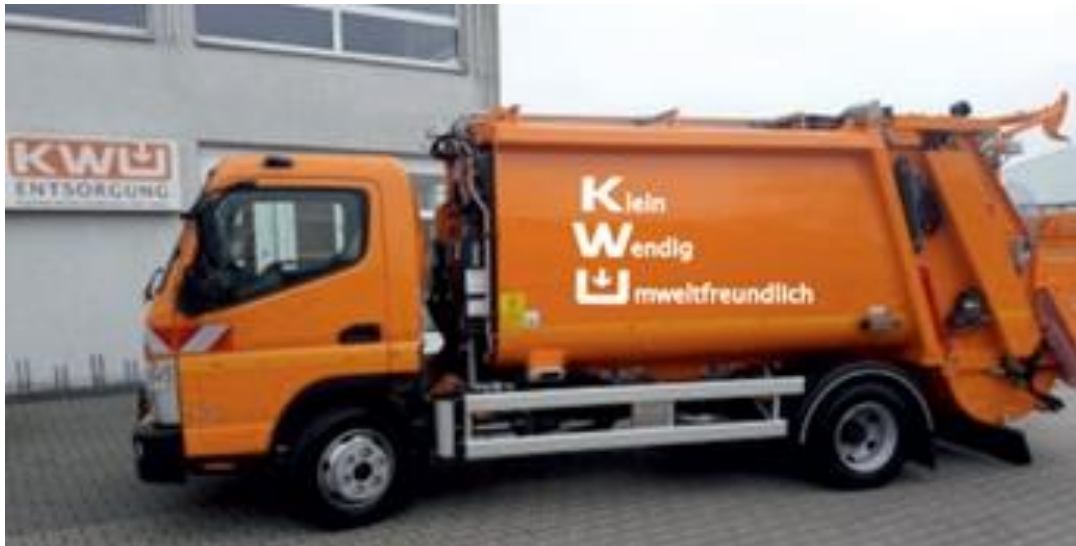
Foto 8: Kleines Entsorgungsfahrzeug mit Heckladeeinrichtung (Fuso) zur Entsorgung von Restabfall, PPK und Bioabfällen für Gebiete, in denen die regulären Entsorgungsfahrzeuge nicht fahren können
